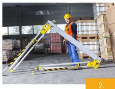
FSB - Sequenza di apertura della gru a portale
