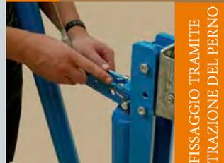
FISSAGGIO TRAMITE TRAZIONE DEL PERNO
