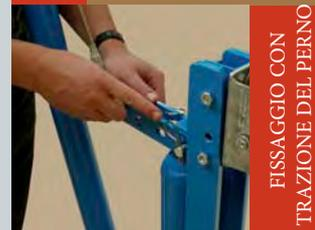
FISSAGGIO CON TRAZIONE DEL PERNO
